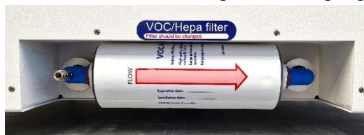
Figur 12.3 Korrekt installerat VOC/HEPA-filter
