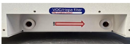
Figur 12.1 Flödespilen på MIRI® II-12 IVF-inkubatorn med flera kammare
