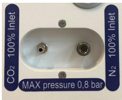
Figur 11.1 Gasinlopp på baksidan av MIRI® II-12 IVF-inkubatorn med flera kammare
